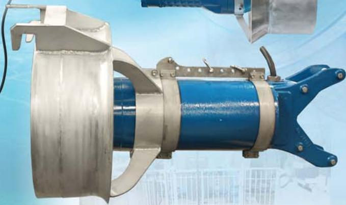
Costruzione compatta, con motore elettrico multipolare, elica a 3 pale con profilo idraulico ottimizzato ad altissimo rendimento, realizzata per ottenere grandi portate a basse prevalenze, interamente fusa in acciaio inox AISI 316. Le potenze variano da 0,6 a 10 kW.
